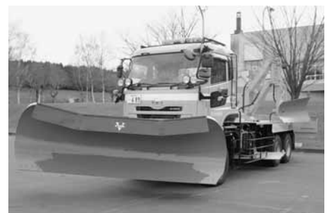
今年度更新された除雪トラックグレーダー機能等を持つ特装車
